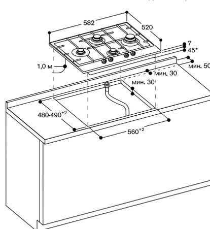
\* 56 мм в диапазоне подключения к газовой сети сзади справа
