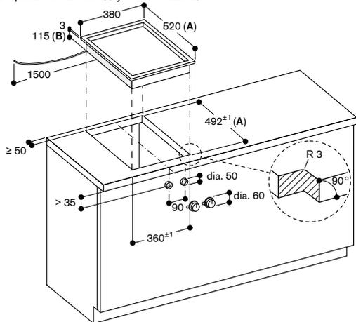
A: При монтаже с крышкой прибора учитывайте глубину выреза (обратите внимание на отдельные указания по планировке)
