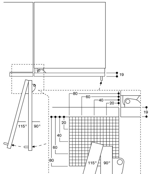
Данные о расстоянии до соседней мебели и ее ручек с учетом размеров петель дверцы, расстояния, проходимого при ее открывании, и толщины фронтальной панели даны на чертеже. На чертеже указаны размеры при толщине фронтальной панели 19 мм.
