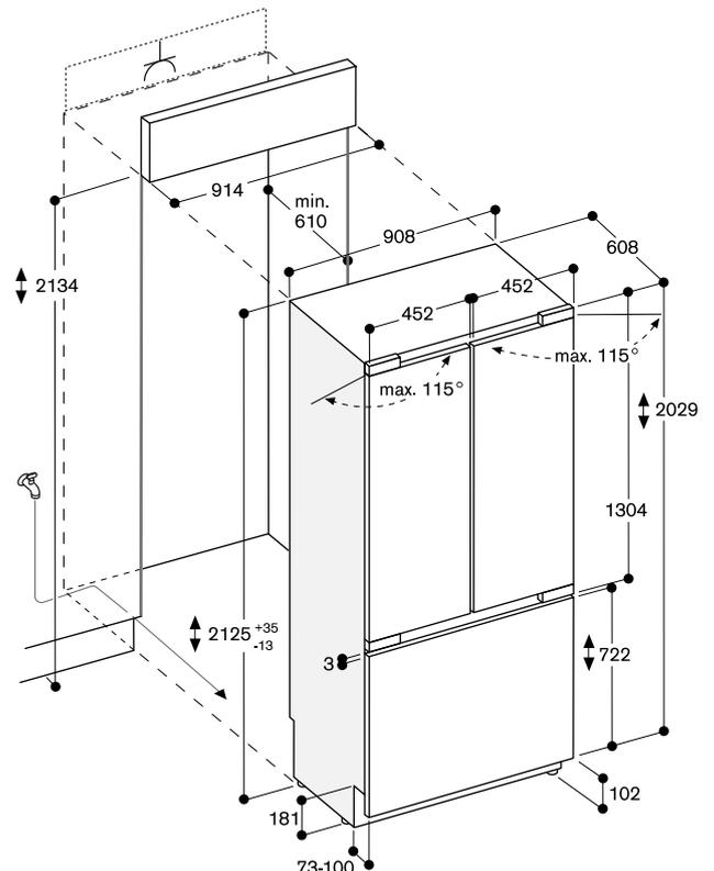
Максимальные размеры фронтальной панели дверей рассчитаны на зазор в 3 мм.
