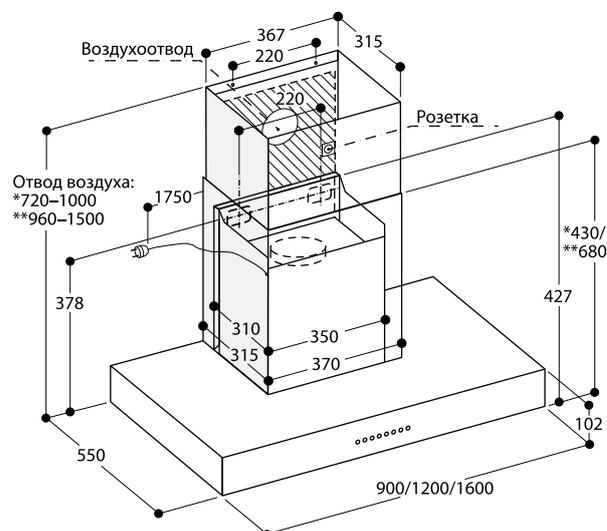
\* С вент. каналом на отвод воздуха AD 442 012, при высоте потолка от 2,35 до 2,60 м.
