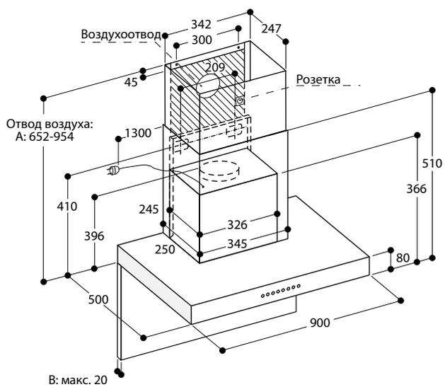
А: предназначено для установки при высоте потолка от 2,25 м до 2,55 м;
