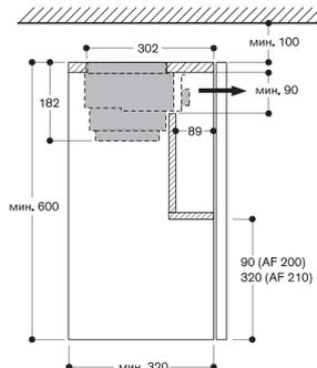
Верхний шкаф, поперечный разрез с AA 211 812 и телескопические рамы AA 210 490/460
