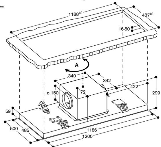
A: Выход вентилятора можно поворачивать во все четыре направления. Размеры в мм
