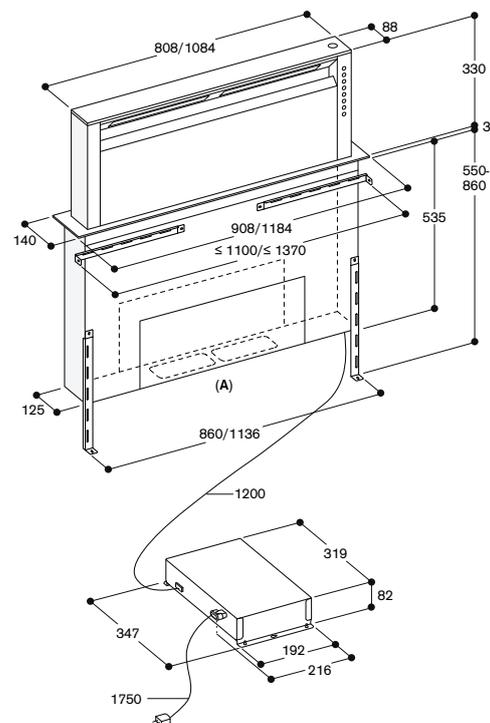
А: Гибкое крепление вытяжки спереди, сзади или снизу
