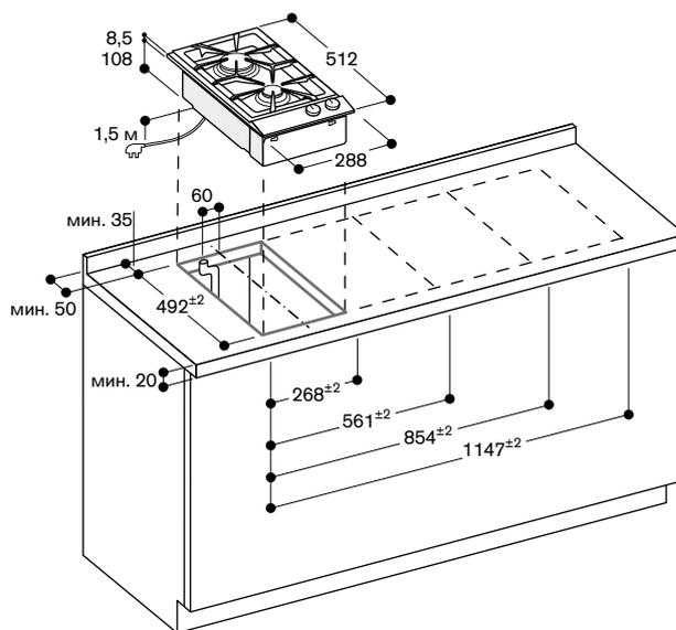
Минимальное расстояние от выреза прибора до боковой стенки 150 мм.
