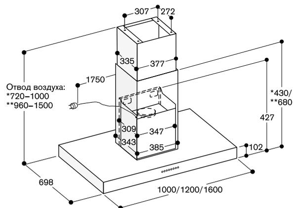
\* С вент. каналом на отвод воздуха AD 442 016, при высоте потолка от 2,35 до 2,60 м.
