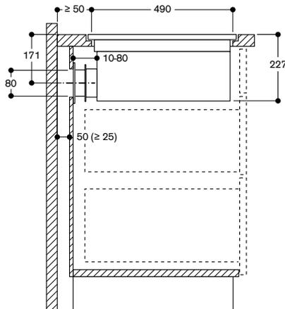
Не рекомендуется для неизолированных наружных стен ( $U \geq 0.5 \text{ Вт/м}^2 \text{ °C}$ )
