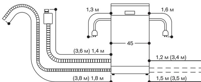
( ) значения при установленном удлинителе
