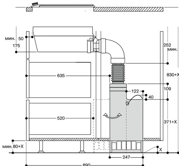
**Пример монтажа (рециркуляция воздуха) установка напрямую VL 200 с AR 413 122**
