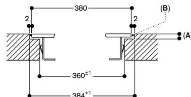
A: 3.5<sup>-0.5</sup> в комбинации с безрамной индукционной плитой
