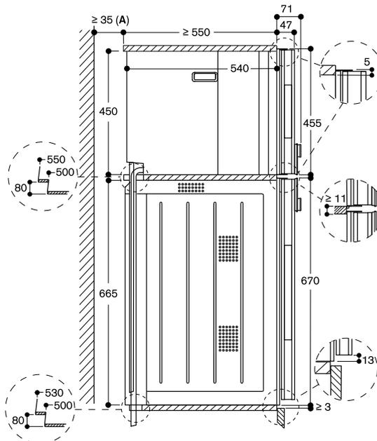
A: Требуется только в случае, если нет возможности провести шланги водоснабжения BS в угловые углубления прибора.
