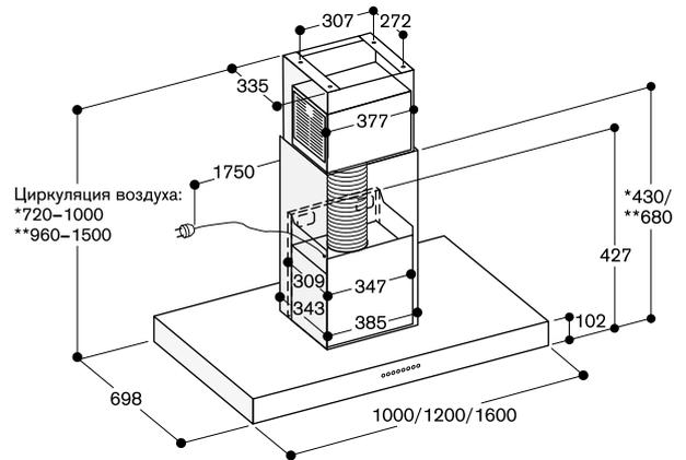
\* С вент. каналом на рециркуляцию воздуха AD 442 116, при высоте потолка от 2,35 до 2,60 м.
