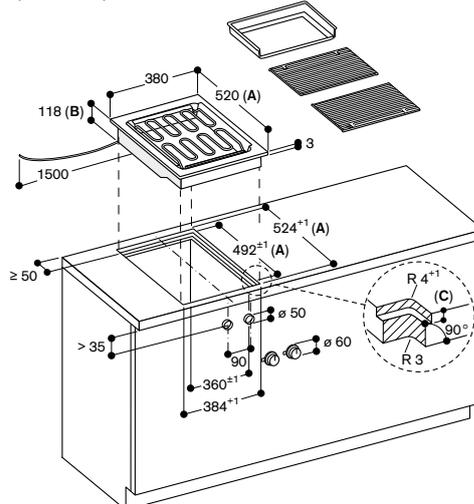
A: При монтаже с крышкой прибора учитывайте глубину выреза (обратите внимание на отдельные указания по планировке)
