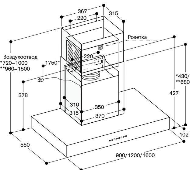
\* С вент. каналом на рециркуляцию воздуха AD 442 112, при высоте потолка от 2,35 до 2,60 м.
