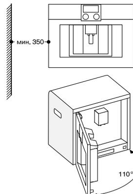
При применении ограничения петли на 92° (номер запасной детали 00636455), мин. расстояние к стене составляет всего 100 мм
