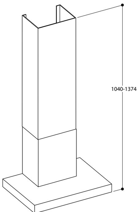
\* Предназначено для установки при высоте потолка от 2,64 м до 2,97 м;
