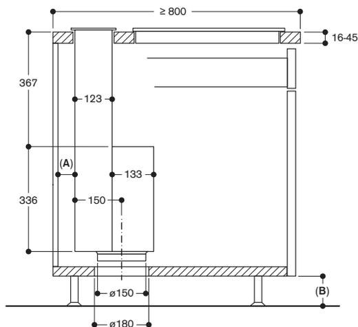
A:  $\geq 20$  мм между зоной всасывания Guided Air и стенкой шкафа
