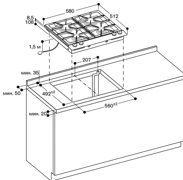
Минимальное расстояние от выреза прибора до боковой стенки 150 мм.
