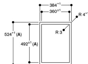
A: При монтаже с крышкой прибора учитывайте глубину выреза (обратите внимание на отдельные указания по планировке)
