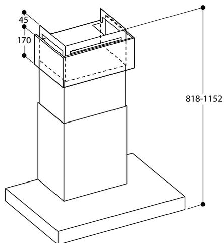
\* Предназначено для установки при высоте потолка от 2,45 м до 2,75 м;
