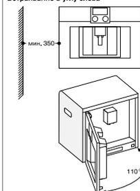
При применении ограничения петли на 92° (номер запасной детали 00630456), мин. расстояние к стене составляет всего 100 мм
