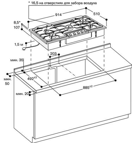
Минимальное расстояние от выреза прибора до боковой стенки 300 мм.
