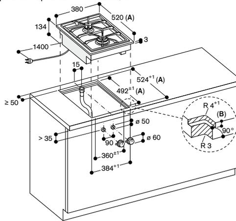
A: При монтаже с крышкой прибора учитывайте глубину выреза (обратите внимание на отдельные указания по планировке)
