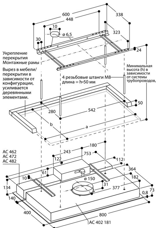
При сложной конфигурации: допустимый размер прогиба перекрытия в области выреза: макс. + 3 мм. Упор для предотвращения выгибания по центру достигается посредством фиксации модуля. Необходимые резьбовые штанги, гайки, крепежные винты входят в стандартный комплект поставки.
